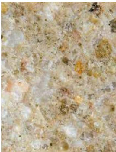
Īpašais materiālu sastāvs un mūsdienīgas ražošanas tehnoloģijas nodrošina ACO polimērbetonam izcilu profilu. ACO polimērbetona izstrādājumiem, piemēram, salīdzinot blīvumu, ir ievērojami lielākas izturības vērtības un vieglāks svars nekā citiem betona izstrādājumiem.
