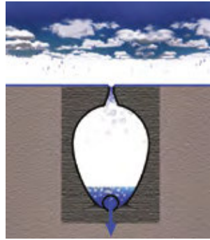
Nokrišņu sākums. Kanāls piepildās atkarībā no pieslēguma caurules izplūdes spējas
