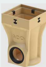
Augsts noteces gūlija ar horizontālo cauruļu savienojumu DN 100 un LLD-blīvi, produkta Nr. 319604
