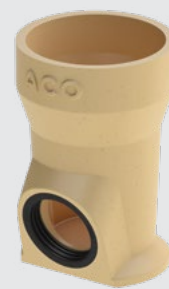
Augsts/apaljš noteces gūlija savienošanai ar augšgalu, ar horizontālo cauruļu savienojumu DN 100 un LLD-blīvi, produkta Nr. 319605
